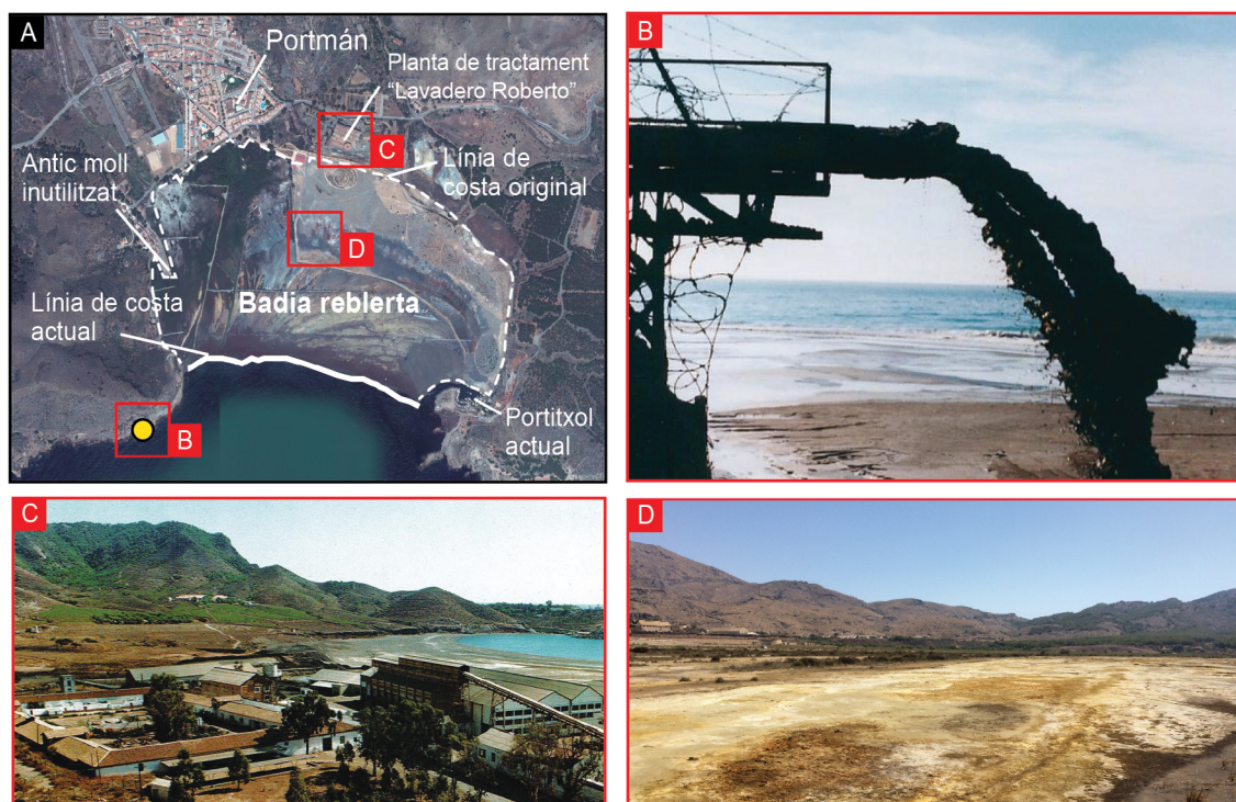
Figura 1.15 Imatges dels abocaments a la badia de Portmán i els seus efectes. A) Ortofotomapa actual de la badia on es mostren un seguit d'elements rellevants i la situació de les imatges B, C i D. B) Fotografia de la boca de la canonada que abocava els residus miners a la costa. C) "Lavadero Roberto", planta de processament del mineral per flotació diferencial. D) Superfície de la part emergida dels dipòsits de rebliment de la badia. Les fotografies B i D i 3 són de Banos-González i Páez (2013).
