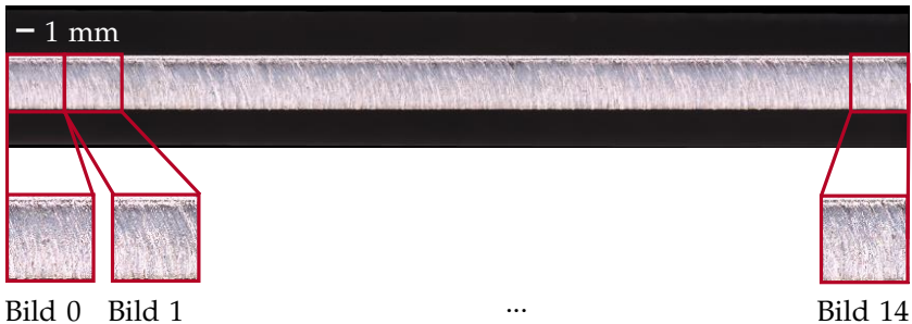
Abbildung 4.6 Vorverarbeitung der Bilder zur Verwendung als Eingangsdaten für neuronale Netze. Zuerst wird die Schnittkante des hier gezeigten Originalbildes freigestellt und horizontal ausgerichtet. Dann wird sie in 15 quadratische Bilder zerschnitten (von denen hier drei gezeigt sind). Die quadratischen Bilder werden auf die einheitliche Größe von 224 \times 224 Pixeln skaliert.
