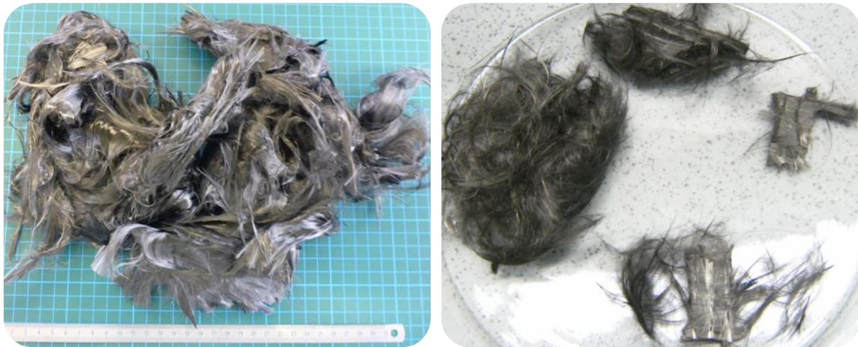
Abbildung 55: Zurückgewonnene Carbonfasern nach der Behandlung mit überkritischem Wasser (links) und mit angesäuertem Polyethylenglycol (rechts).
