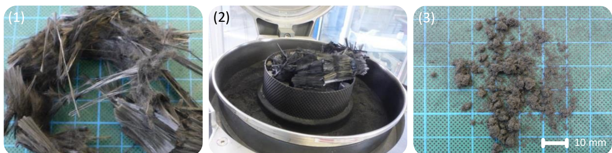
Abbildung 47: Material vor Aufgabe in die Zentrifugalmühle (1), Blick in die Zentrifugalmühle (2), Material nach Zerkleinerung (3).
