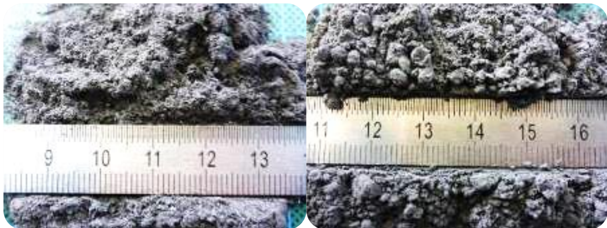
Abbildung 52: CF- (links) und CFK-Füllstoff (rechts) nach der Zerkleinerung in der Kugelmühle.
