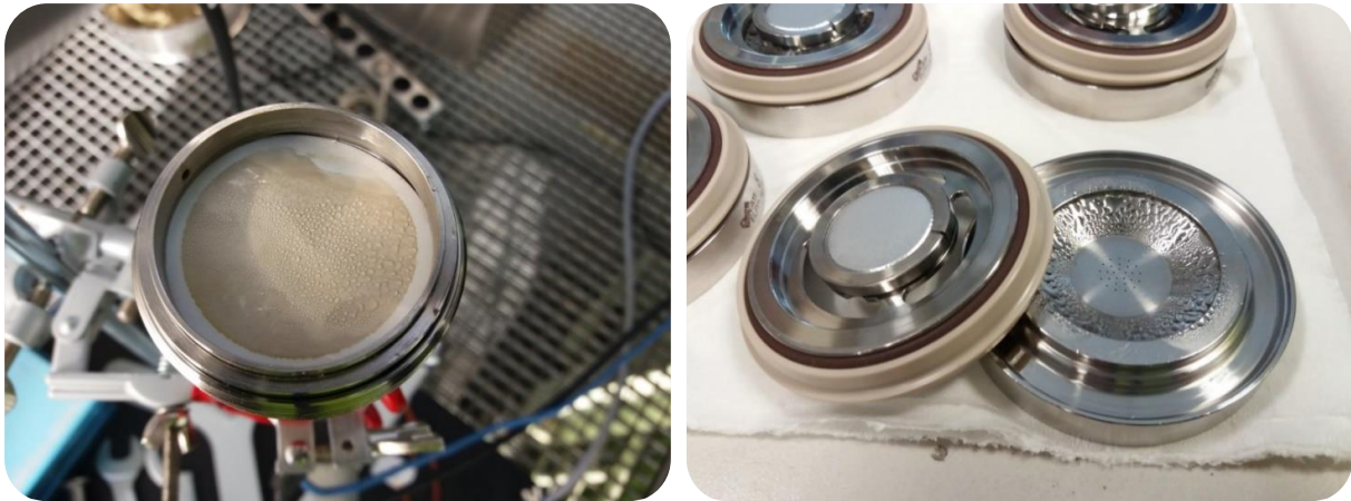
Abbildung 85: Planfilter mit Wasserdampfkondensation bei Messung nach Wäscher (links), Impaktorscheibe mit Wasserdampfkondensation im Reingas am Kamin (rechts).
