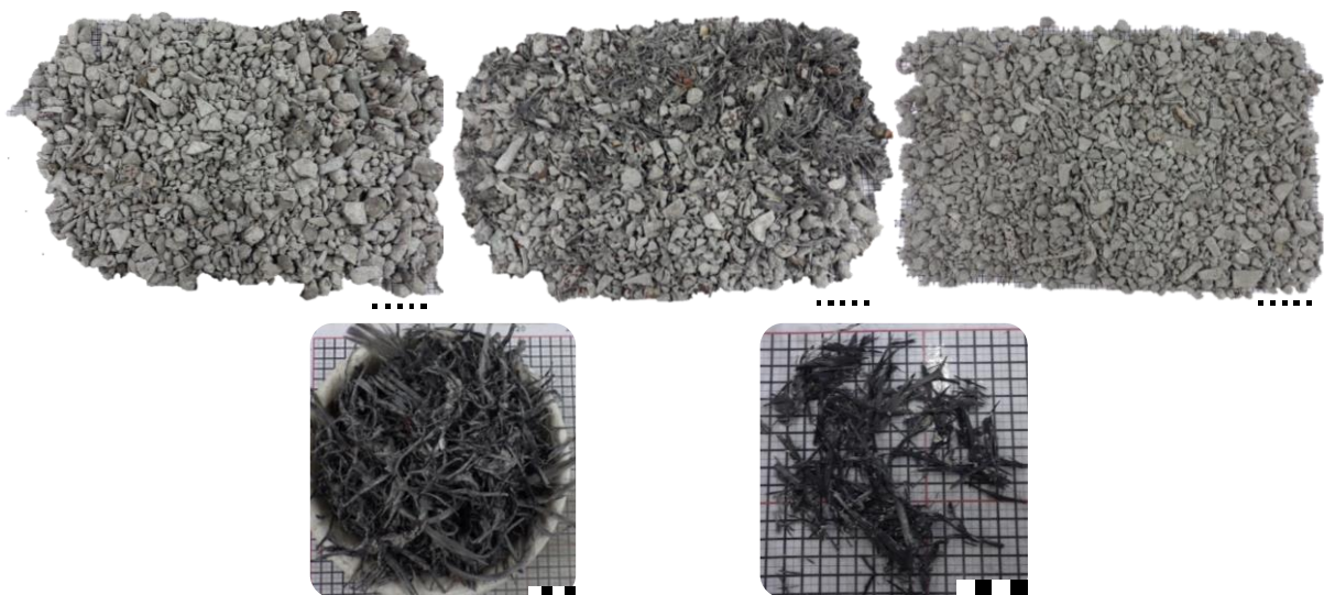
Abbildung 66: Versuchskampagne am MHKW Coburg. Oben: Erzeugte Kornfraktion 10-30 mm (vlnr: Referenz, CF-Mitverbrennung und Kontrolle). Unten: Aussortierte CF (links Kornfraktion 10-30 mm, rechts 1-10 mm) [Maßstab Kästchen = 1 cm].
