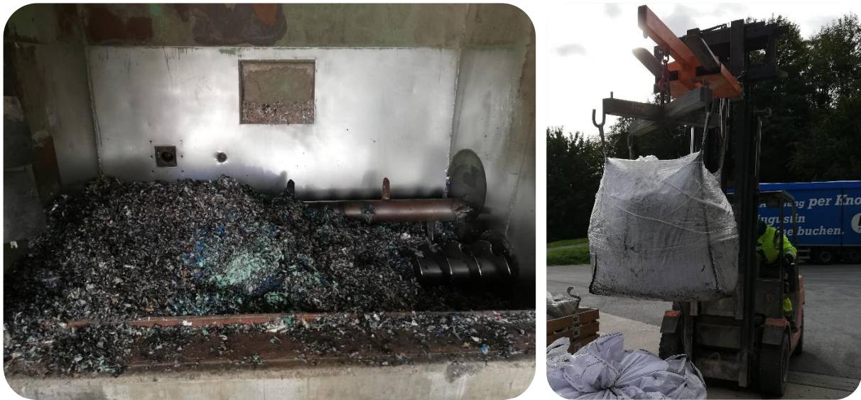
Abbildung 36: Ersatzbrennstoffzugabe mit carbonfaserhaltigem Fluff (links) und Fluff-Big Bag.
