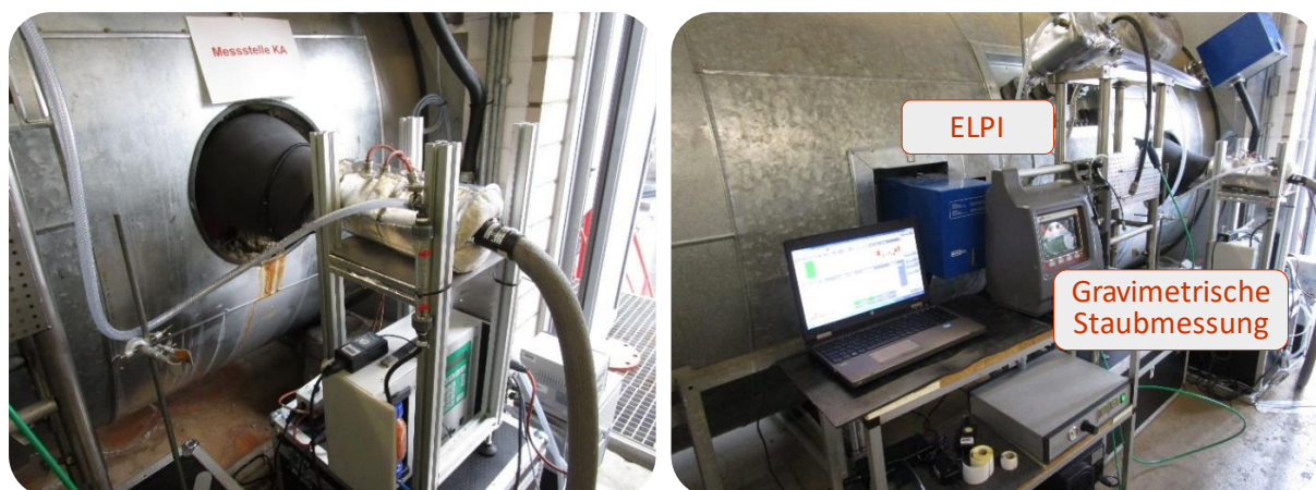
Abbildung 23: Aufbau der Messungen am Kamin.
