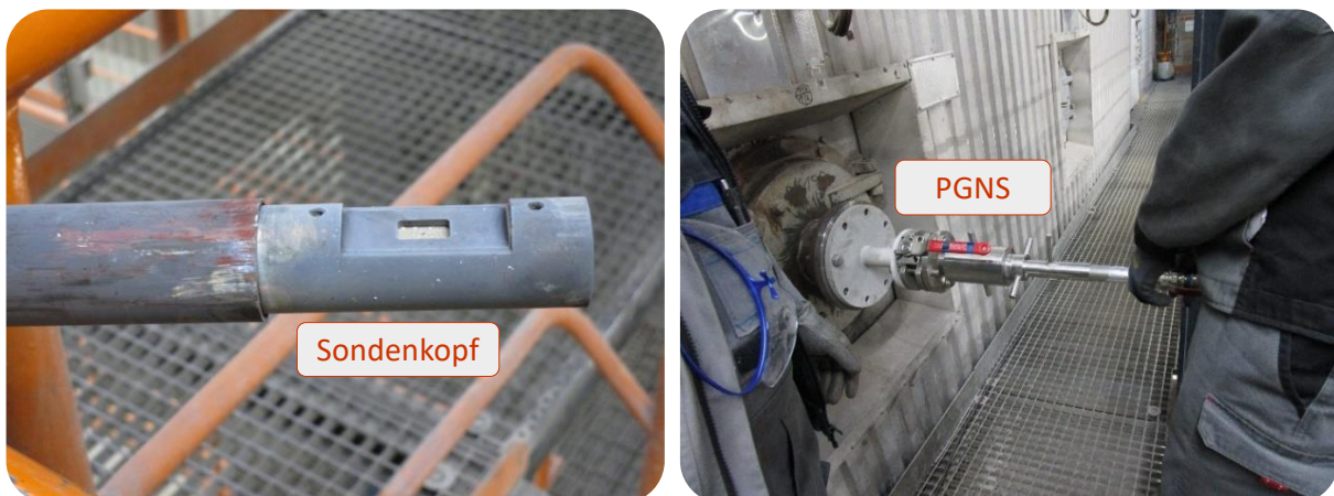
Abbildung 21: Sondenkopf der PGNS (links) und Sonde im Messeinsatz (rechts).
