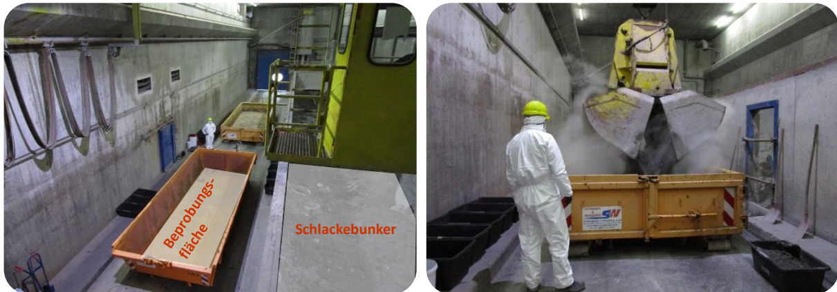
Abbildung 18: Beprobung der Rostasche (links: Schlackebunker und Transportcontainer als Beprobungsfläche, rechts: Abwurf der Rostasche).
