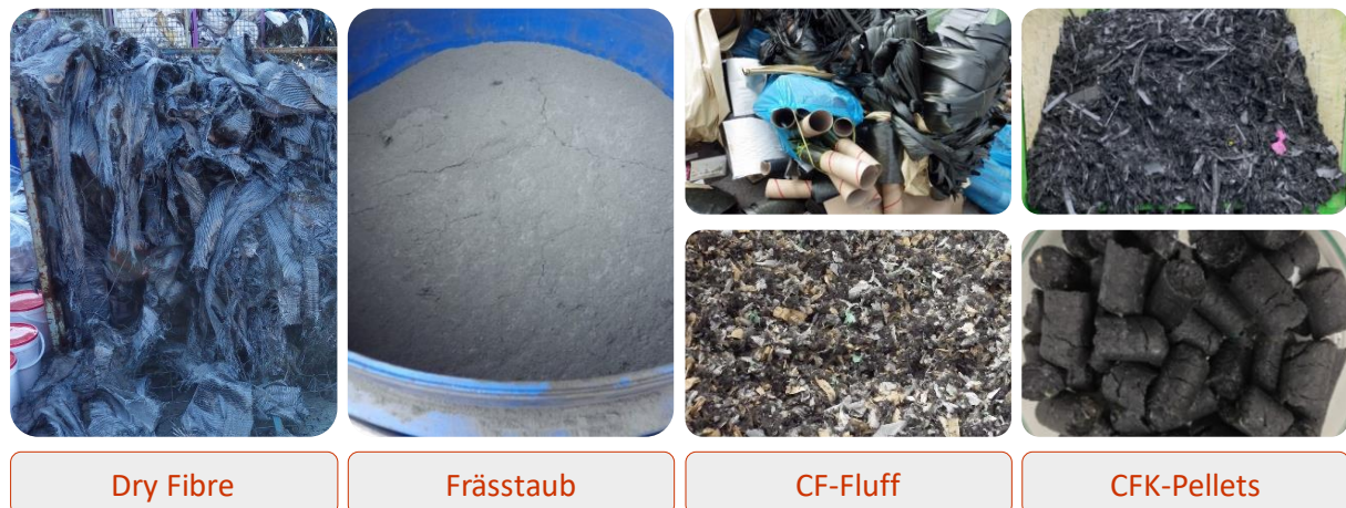
Abbildung 15: Für die Großversuche eingesetzte carbonfaserhaltige Abfälle (Herstellung CF-Fluff und CFK-Pellets: oben Ausgangsmaterial, unten nach Aufbereitung).
