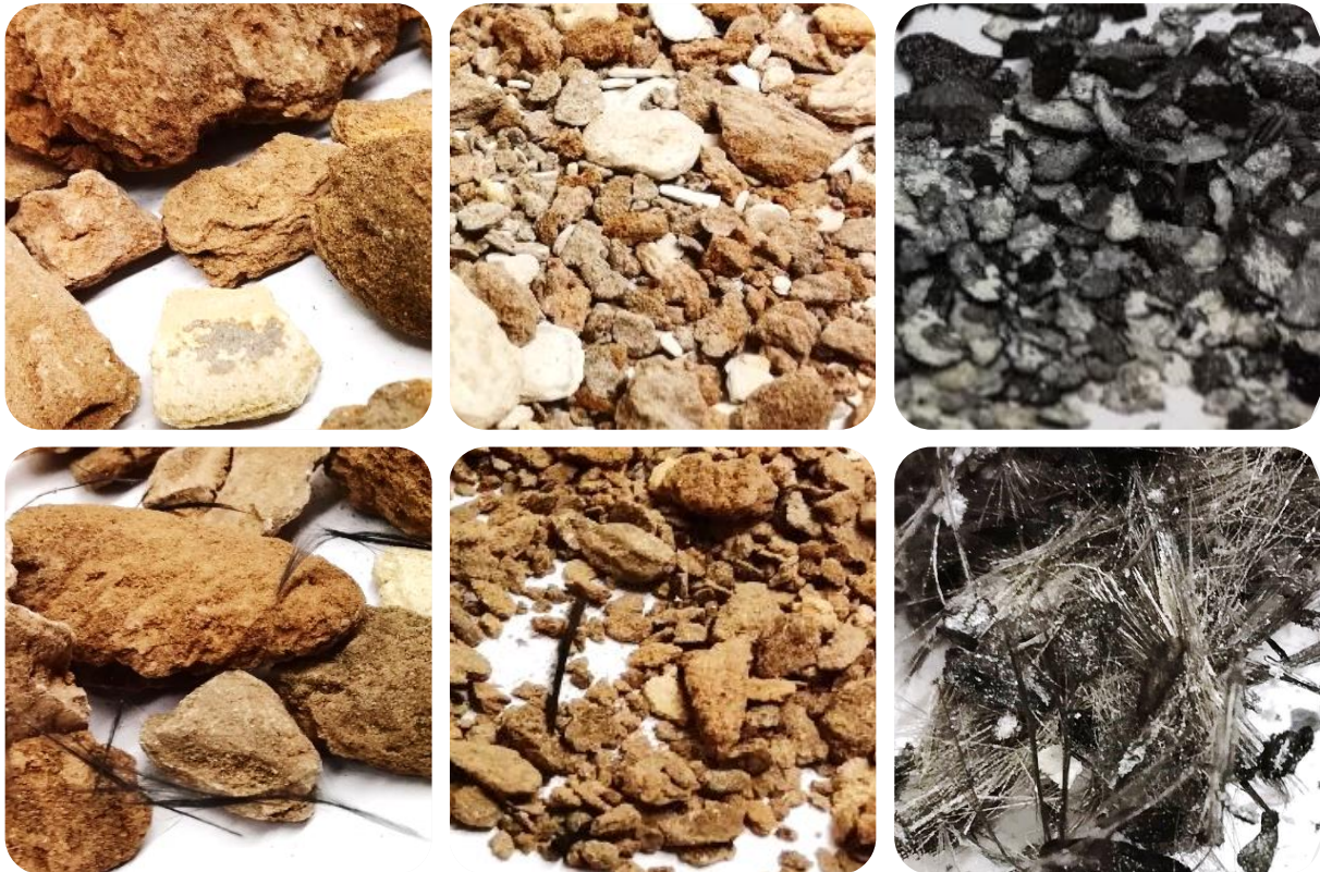
Abbildung 67: Vergleich von Kesselaschen (links und Mitte) und Gewebefilterasche (rechts) während Referenz (oben) und CF-Mitverbrennung (unten) im MHKW Coburg.
