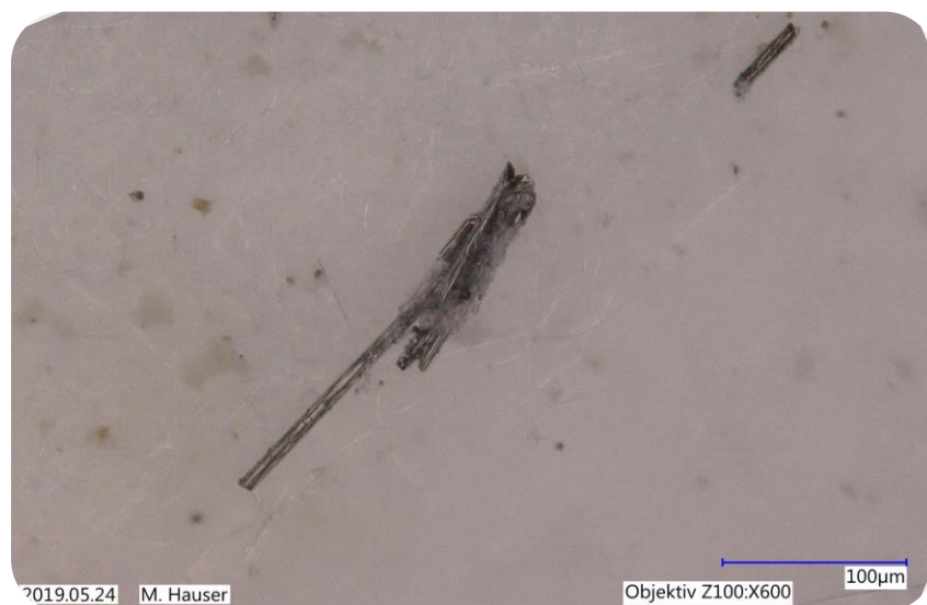
Abbildung 112: Carbonfasern im Reingas der Schwadenabluft nach dem Gewebefilter, während der Versuchswoche unter Zugabe von 5 Mg CFK Pellets/d.
