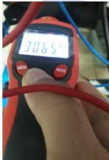
Gambar 7 Proses uji coba pengukuran putaran mesin menggunakan alat ukur Tacho Meter
