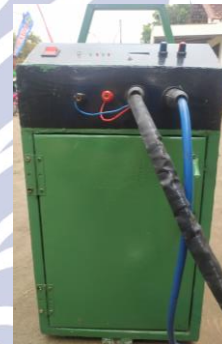
Gambar 4. Tampak Depan Weld point untuk Perbaikan Bodi Kendaraan
