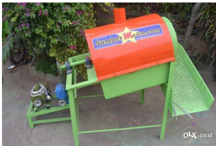
Gambar 2. Penggorengan Kerupuk Pasir Penggerak Motor Listrik
