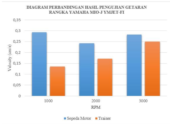
Gambar 8. Perbandingan getaran rangka sepeda motor dan trainer (cm/s)
