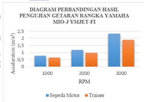
Gambar 7. Perbandingan getaran rangka sepeda motor dan trainer (m/s 2 )
