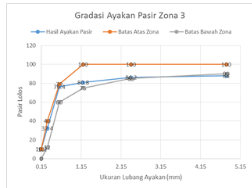
Gambar 6. Gradasi Pasir Zona 3
