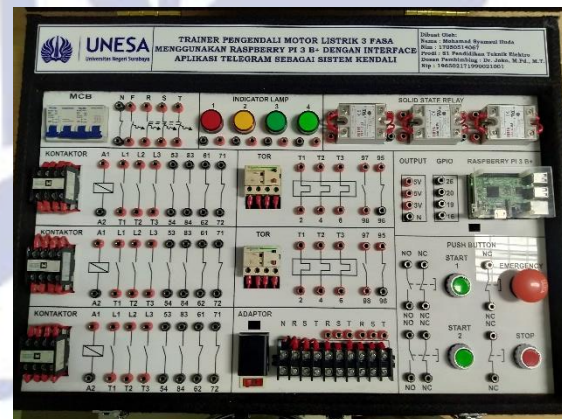
Gambar 3. Tampilan trainer pengendali motor listrik 3 fasa menggunakan raspberry pi.
