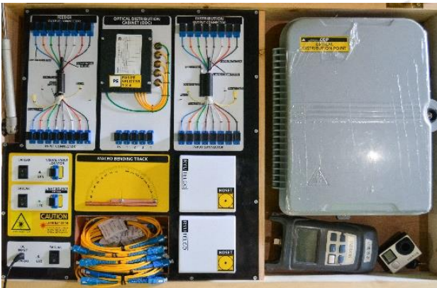
Gambar 3. Trainer Instalasi Perangkat Pasif Jaringan Fiber optic
