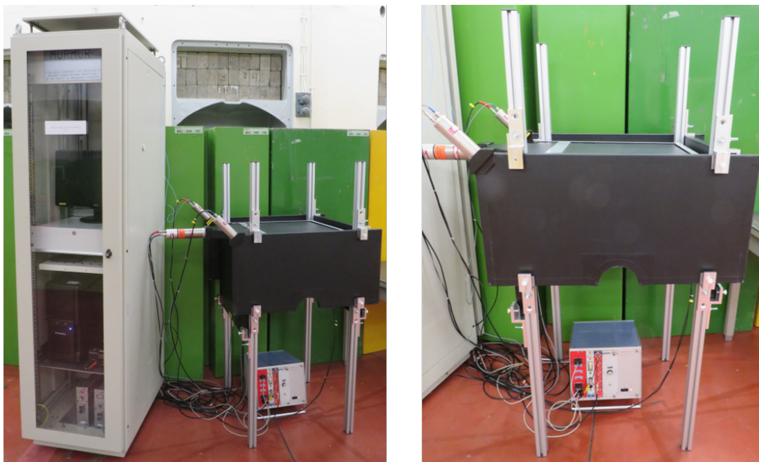
FIGURE 10.2 – Photographie du blindage actif, constitué de 4 scintillateurs plastiques sur les côtés, et d'un scintillateur sur le dessus.
