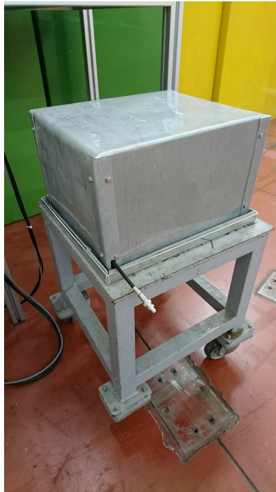
FIGURE 10.1 – Photographies du blindage passif additionnel fait de 2 mm de cadmium.
