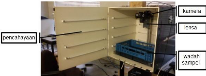
Gambar 6. Sistem CV Statis Berupa Kotak 70 m 3 dengan Penerangan Lampu Fluorescent , Kamera Canon dan Wadah untuk Sampel.
