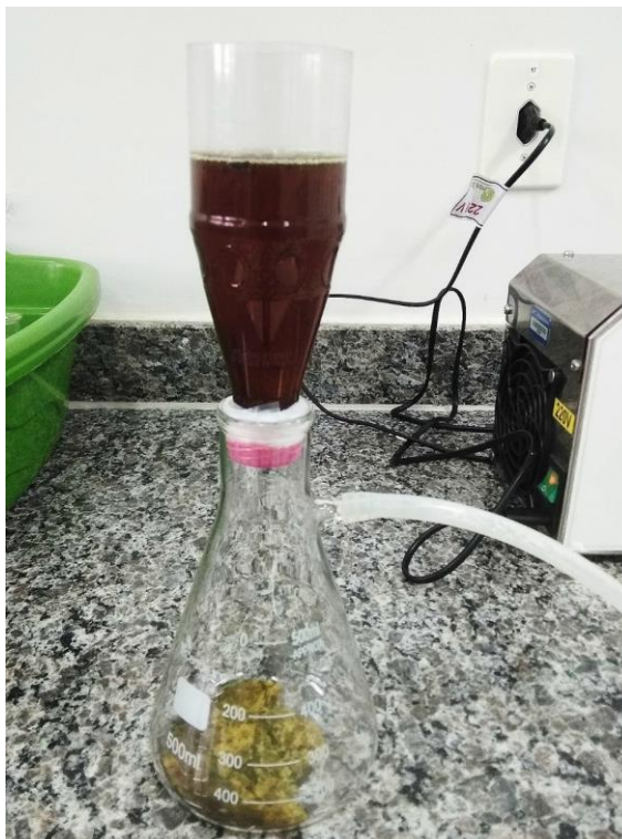
Figura 10: Coluna de purificação.
