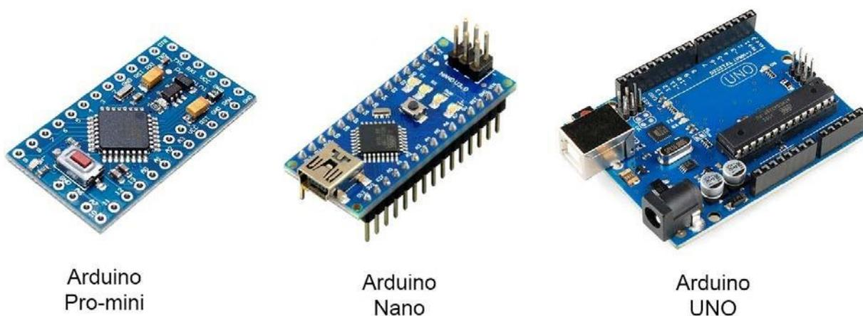
Figura 10 – Versões do Arduino, neste projeto foi utilizado apenas o Arduino Nano (NUNES, 2018)
