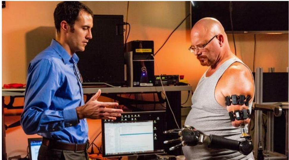
**Figura 3.4** – Johnny Matheny (direita) utilizando dois Myo Armbands para controlar uma prótese acoplada diretamente na estrutura óssea de seu braço. O projeto é uma parceria entre o Governo Norte-Americano (DARPA) e a Universidade Johns Hopkins (EUA). *Fonte: Wareable.com*
