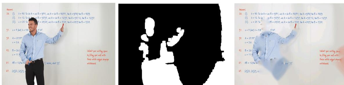
Figura 6.7: Exemplo de falha no módulo de inpainting do quadro branco.
