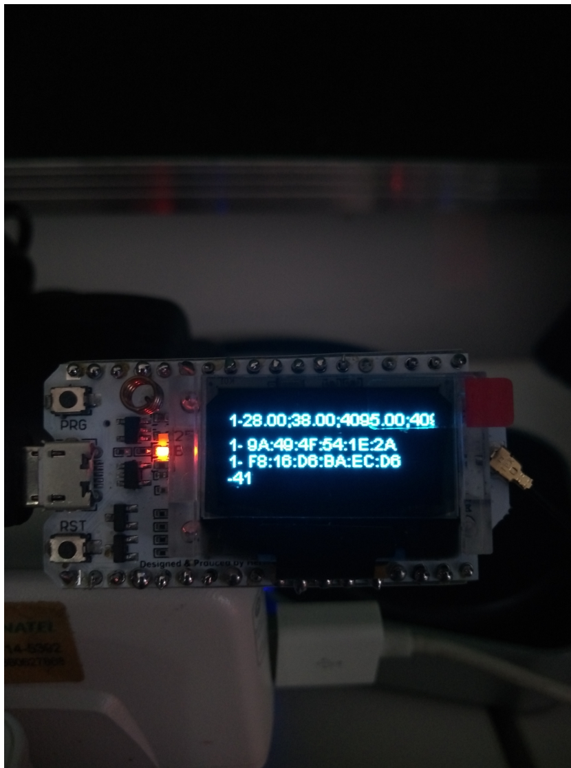
Figura 4.7: Gateway LoRa mostrando MAC e CHIPSET da Estação 1
