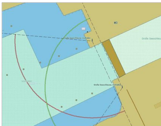
Abb. 6: Einfahrt in eine Schleuse, dargestellt in einer official ENC
