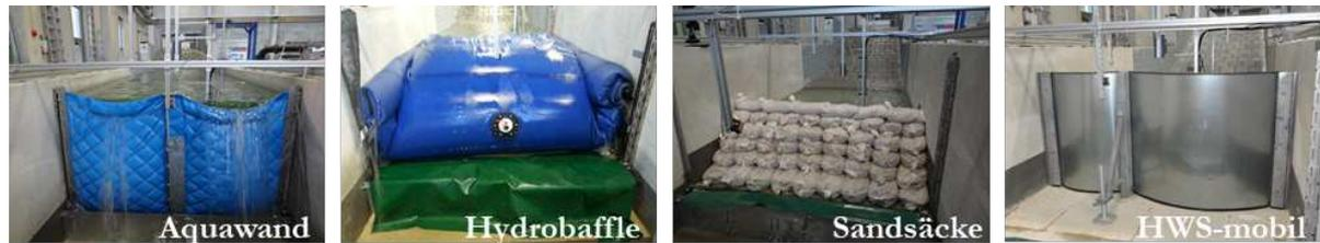
Abbildung 2: Im Labor getestete mobile Hochwasser- bzw. Küstenschutzmaßnahmen.
