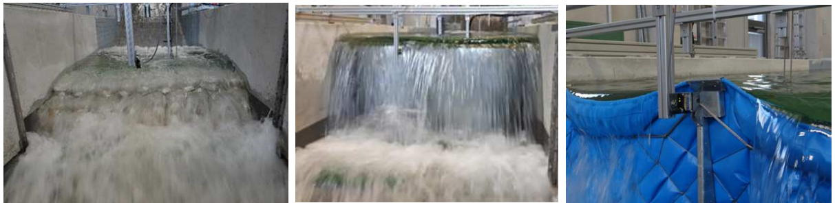
Abbildung 11: Testphase 3 – Überströmen von Sandsackdeich , HWS-mobil und Aquawand .
