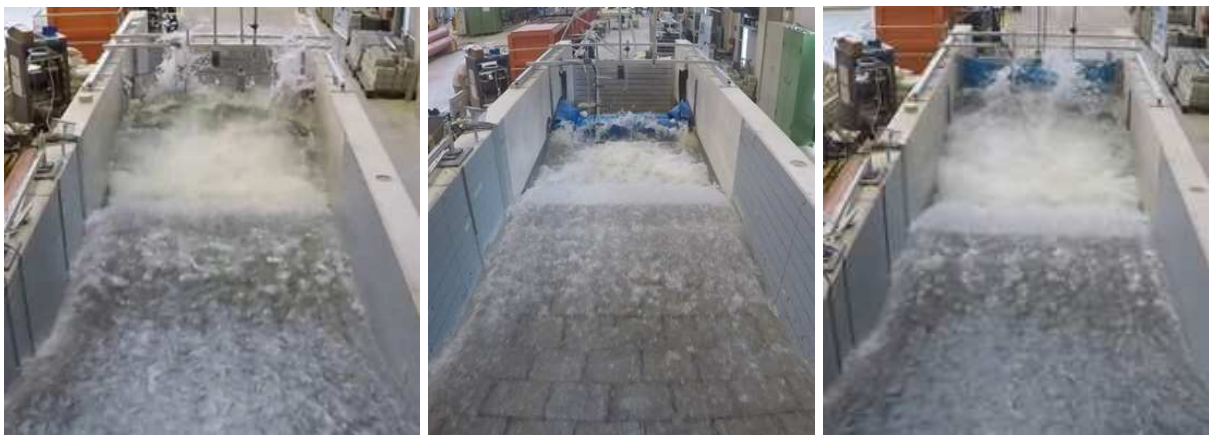
Abbildung 12: Testphase 4 – Wellenanprall auf HWS-mobil , Hydrobaffle und Aquawand .
