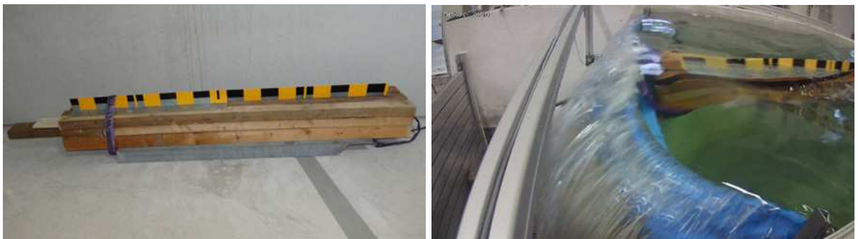
Abbildung 13: Anprallkörper (links) und Anprallversuch an der Aquawand (rechts).
