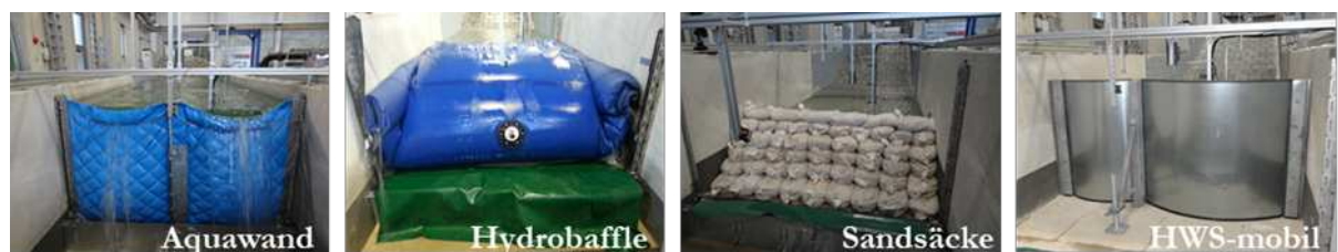
Abbildung 3: Untersuchte mobile Hochwasser- bzw. Küstenschutzmaßnahmen während der Testphase in der wasserbaulichen Versuchshalle.
