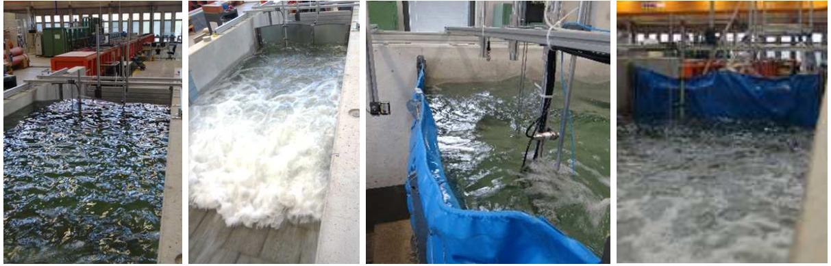
Abbildung 10: Testphase 1 und 2 – Einstau und Anströmen an HWS-mobil und Aquawand .
