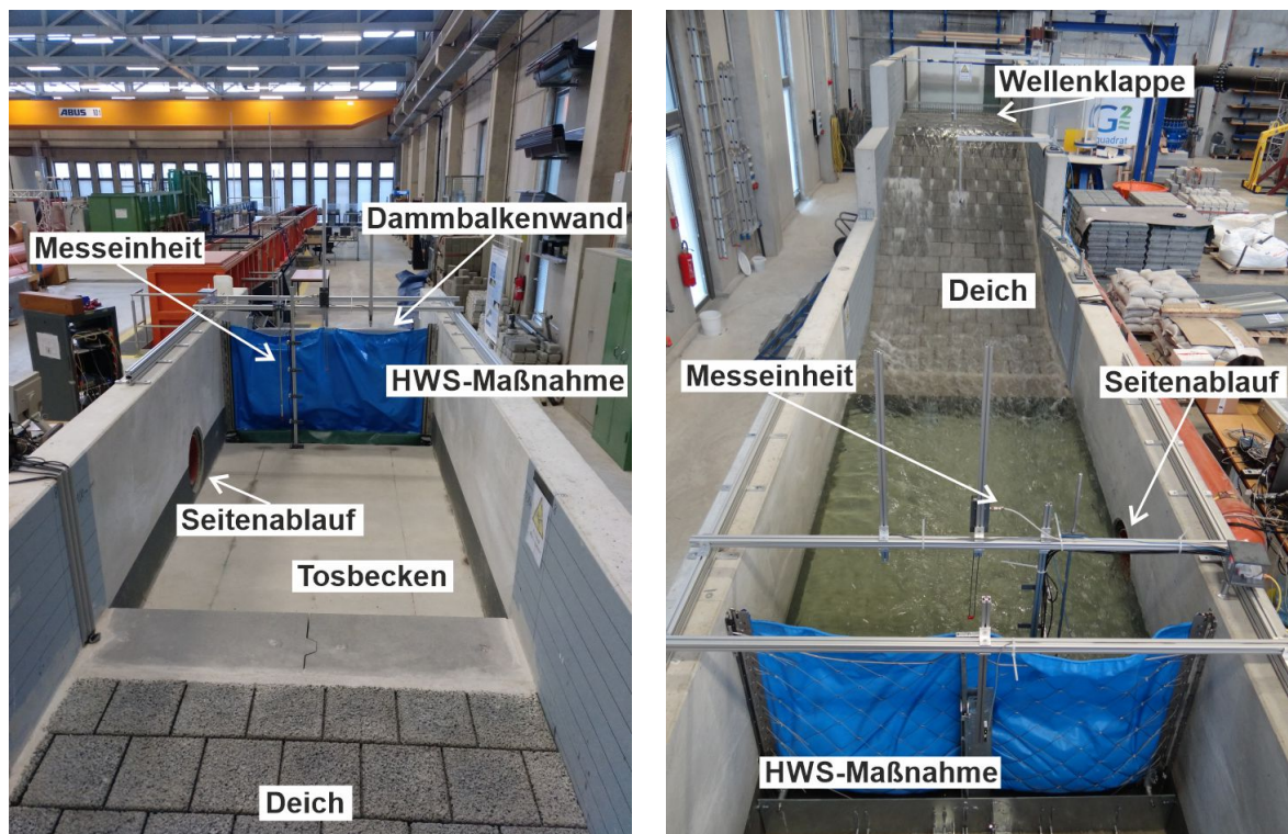
Abbildung 6: Versuchstand (links: Blickrichtung von Deichkrone, rechts: polderseitiger Blick).
