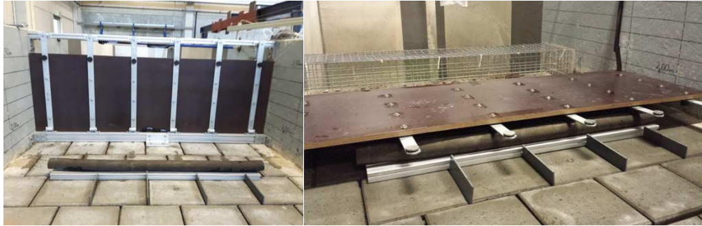
Abbildung 7: Wellenklappe in geschlossenem (links) und geöffnetem (rechts) Zustand.
