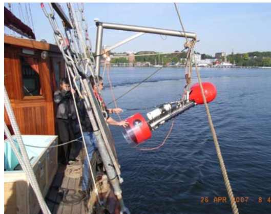
Abb. 2: Aussetzen eines Side Scan Sonars mit adaptiertem Subbottomprofiler an Bord der »Gotland«
