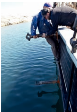
Abb. 4 (rechts oben): Multibeam-Schwinger in der Transit-Position
