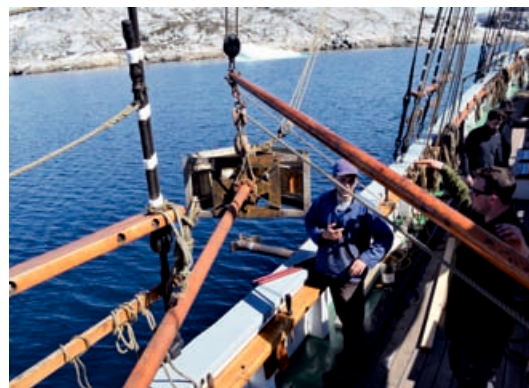
Abb. 6: Installation der Multibeam-Schwinger-Halterung über die Backbordseite: schwieriger Einbau mit Taljen, Bäumen und Muskelkraft
