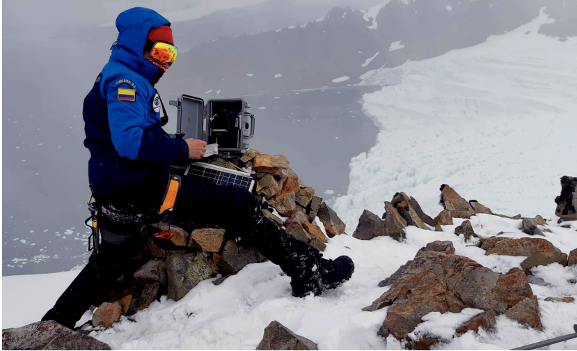
Abb. 1: Installation einer Kamera in wetterfestem Gehäuse am Lange Glacier, King George Island
