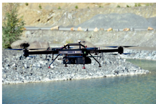
Abb. 5: Der auf einen RiCOPTER montierte RIEGL BDF-1 (links) während der Aufnahme über einem gefluteten Steinbruch (rechts)
