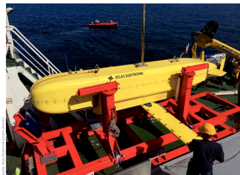
Abb. 5: ATLAS DeepDiver-AUV mit Sub-Bottom-Profiler an Bord eines Arbeitsschiffes
