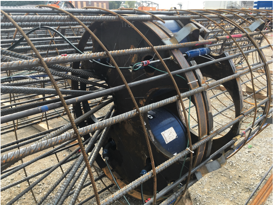
Abbildung 11: Eingebaute Osterbergzelle und Wegaufnehmer
