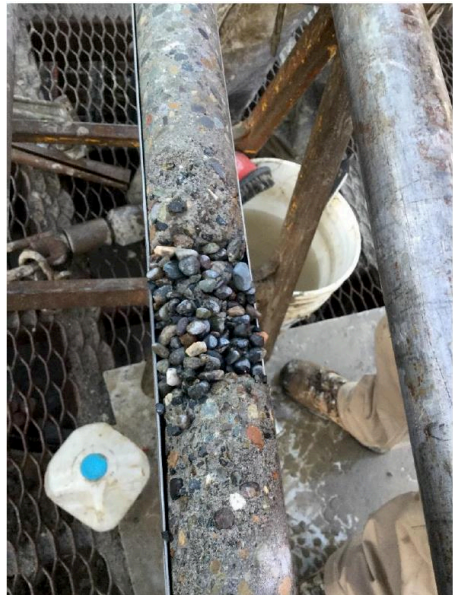
Abbildung 7: TIP-Anomalie in knapp 30 m (90 ft) Tiefe und Kernbohrung mit zugehörige Fehlstelle [Piscsalko et al, 2016]
