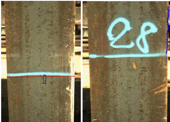
Abbildung 6: Definition der Bezugslänge (links) und Punktverfolgung bei der Schlagrammung (rechts)
