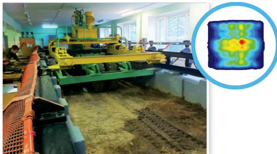
Abbildung 3: Messungen von Reifenkontaktspannungen in einem Überfahrversuchsstand (Tekscan Inc. 2016)
