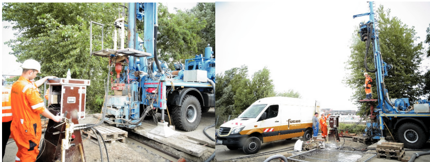
Abbildung 4: Mobiles Drucksondiergerät fixiert am Bohrkopf
