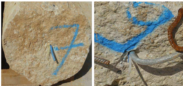
Abbildung 9: Ausgegrabene Säulenstücke – CFA 7 mit FBG-Sensoren (links), CFA 9 mit vorgespannter Fasensorik und Steckisen (rechts)
