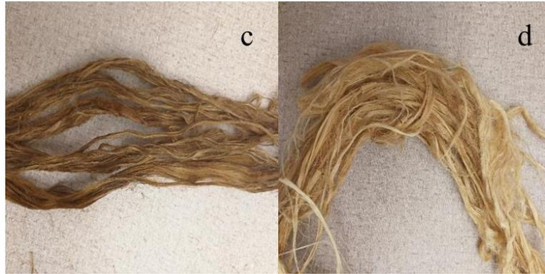
**Fig. 5.1.** Kenaf: (a) Stalk; (b) RKF; (c) AKF; (d) AHPKF
