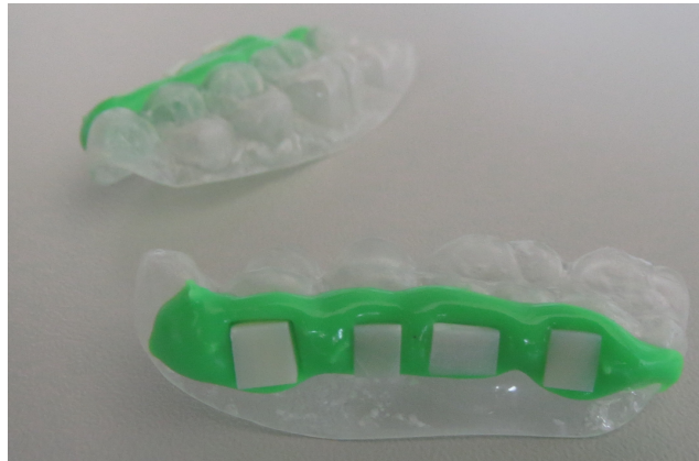
Abb. 2: Trageschiene mit fixierten Schmelzprüfkörpern, Regio 13-17
