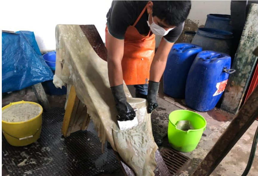
Figura 7: Retiro de fibras mediante el uso de la rancheta sobre lado de la flor.
