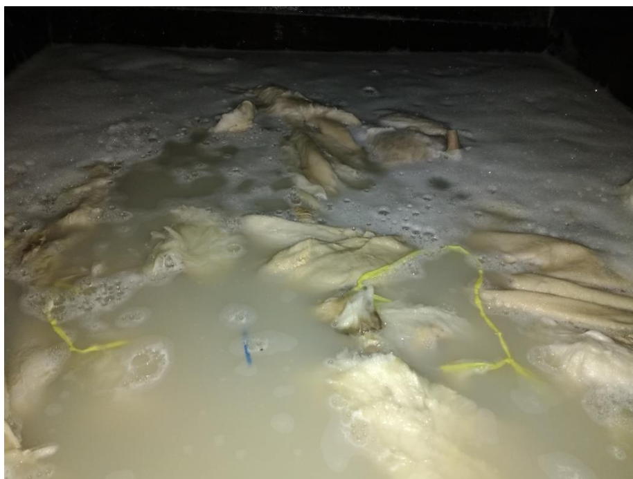
Figura 4: Pielés seco saladas con detergente en pre-remojo, en rotación dentro del botal.
