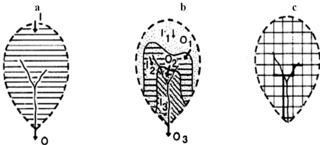
Figura 7. Clasificación de modelos hidrológicos en función a unidades básicas a) Agregado , b) Semidistribuido, c) Distribuido (una aproximación detallada es presentada en la Figura 8). Fuente: Chong-yu Xu, (2002).
