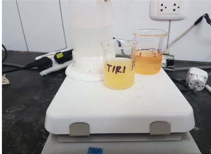
Figura 5: Determinación de la acidez titulable con la base de NaOH.
