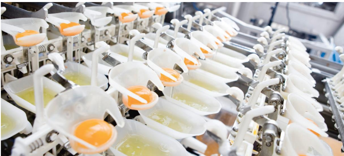
Figura 7: Cascadora mecanizada OPTIBREAKER
