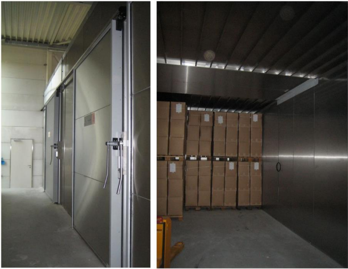
Figura 11: Hot Room utilizado para la pasteurización seca de clara
