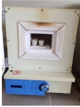
**Figura 9: Equipo mufla para la calcinación**
