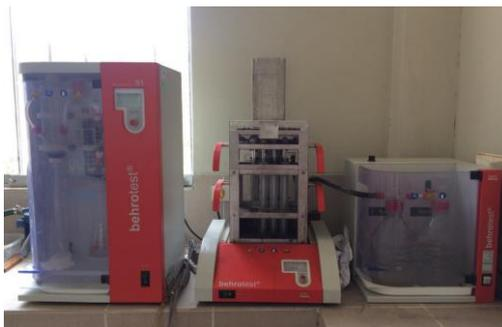
**Figura 8: Equipo kjeldahl de laboratorio**
