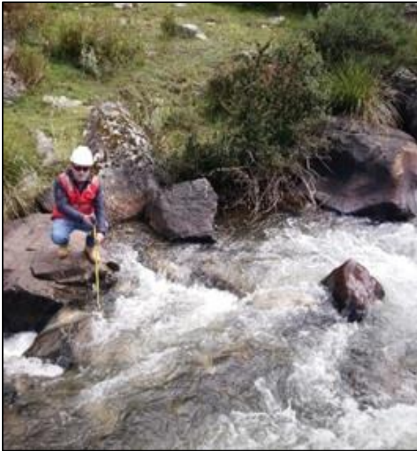
Figura 47: Nivel de marca de agua medido para la calibración del modelo
