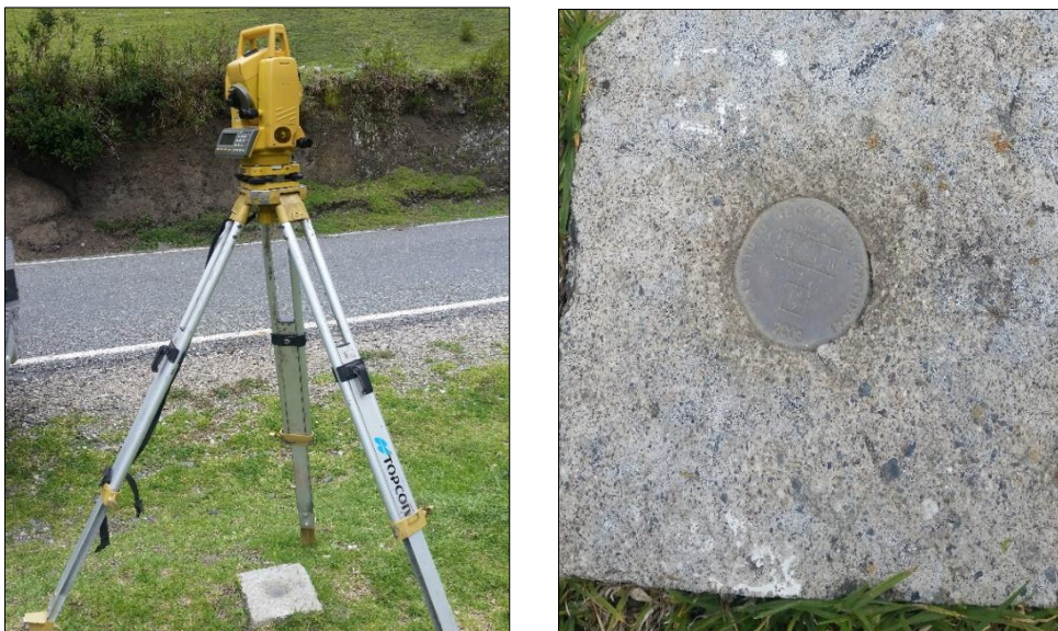
Figura 12: Punto de control topográfico IGN "RCC8". Altura de letrero Pacarenca
