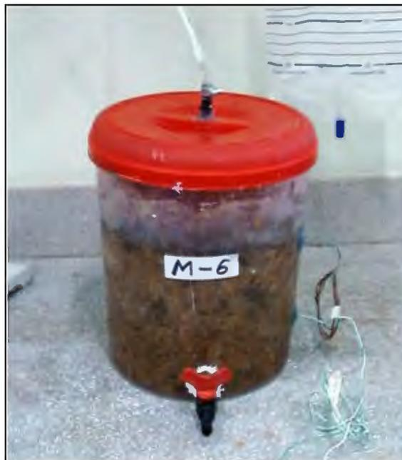
**Figura 15: Biodigestor tipo Bach.**
