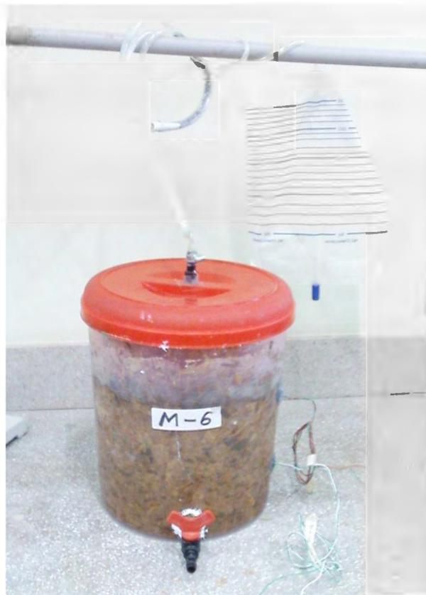
Prototipo del biodigestor de 8 litros
