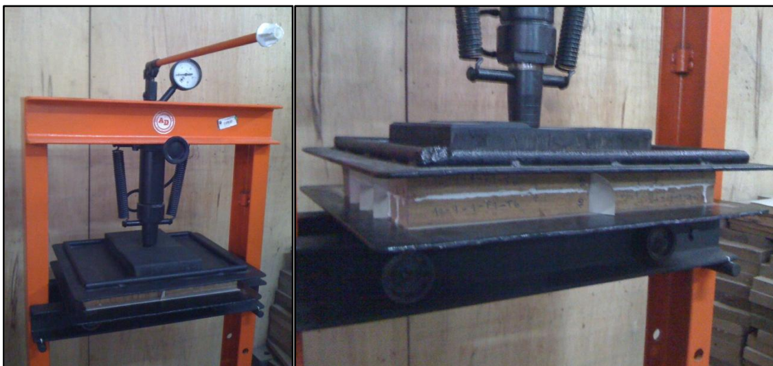
Figura 5: Proceso de prensado de listones
