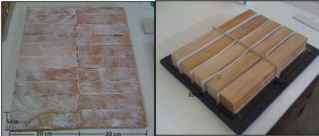
Figura 4: Proceso de encolado de listones
