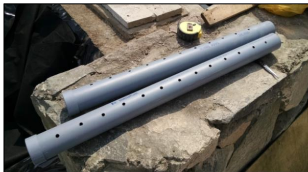
Figura N°16. Tubos de PVC con tapa en sólo uno de los extremos y con agujeros de 1 cm espaciados cada 10 cm
