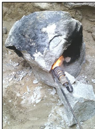
Figura N°13. División de una roca con el equipo lanzallamas
