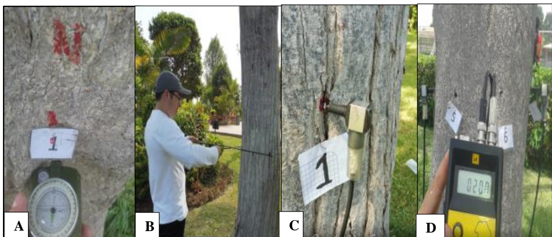
Figura 12. Secuencia de evaluación arbórea con Fakopp Microsecond timer “A” Orientación al norte del punto uno, “B” medida de la distancia entre sensores, “C” introducción del sensor y “D” registro del tiempo luego del golpe con el martillo
