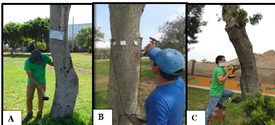
Figura 13. Evaluación de los defectos internos de los árboles “A” Evaluación con maso de goma, “B” Evaluación con Microsecond timer, “C” Evaluación con resistógrafo
