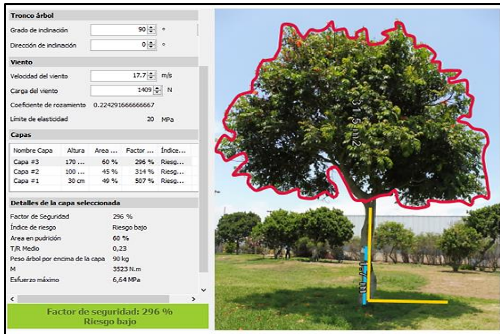
Figura 17. Cálculo de parámetros biomecánicos, mediante ArborSonic 3D 5.2.115
