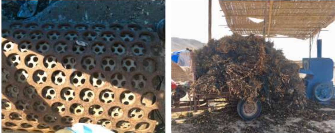
Figura 49 y 50: Cribas de 25,4 mm y 15 mm utilizadas en el molino de martillos. Algas secas ( Macrocystis pyrifera ) entrando a la etapa de molienda
