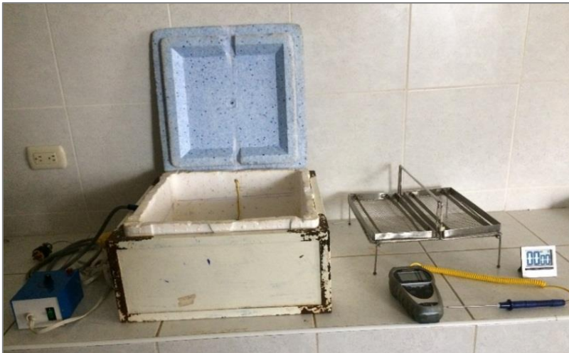
Figura 6: Equipo para congelamiento de semen de tipo manual. (Pulsador de descarga eléctrica, caja de congelamiento, rejilla, Termocupla y reloj cronómetro)
