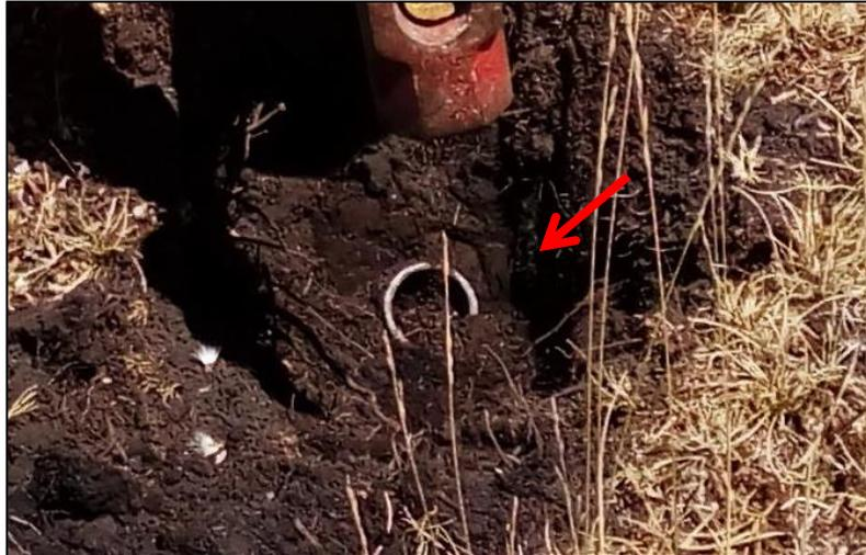
**Figura 2: Proceso de instalación de cilindro metálico en el perfil del suelo**
