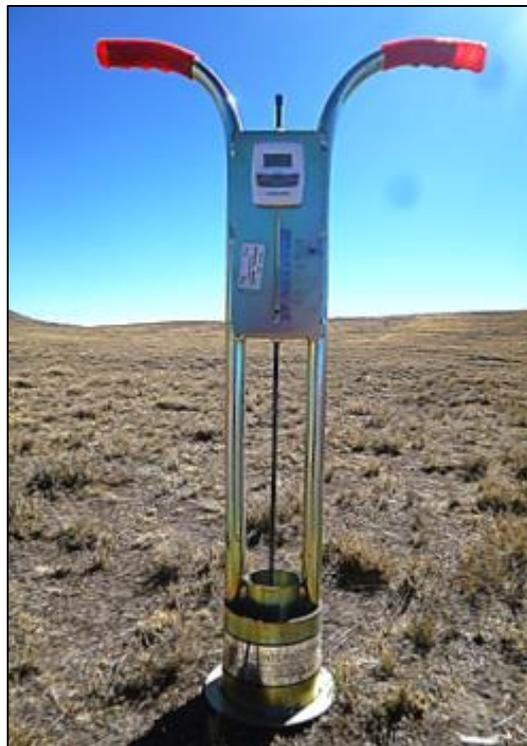
**Figura 1: Equipo infiltrómetro**
