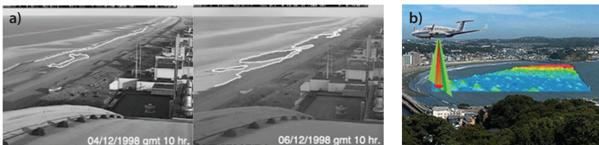
Slika 3: Registracija obale video snimanjem (a); (preuzeto od http://www.coastalwiki.org ) i Metoda snimanja topografskim i batimetrijskim LiDAR-om (b) (preuzeto od https://oceanservice.noaa.gov/education/seafloor-mapping/lidar/ )
