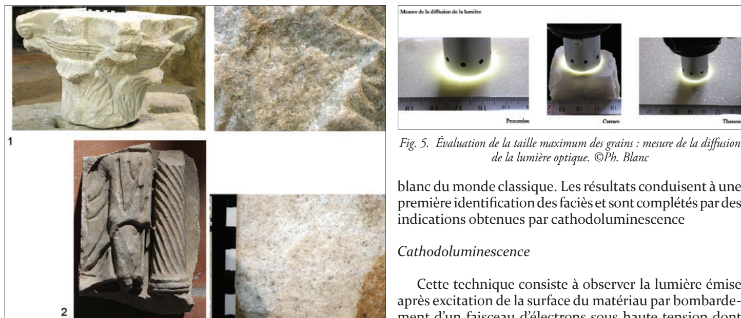
Fig. 4. Taille des grains: 1. Chapiteau, marbre blanc gris à gros grains Narbonne- inv.664 ; 2. Fragment de cuve provenant des fouilles de l'église Saint-Félix, marbre à grains fins de Carrare. ©Ph. Blanc
