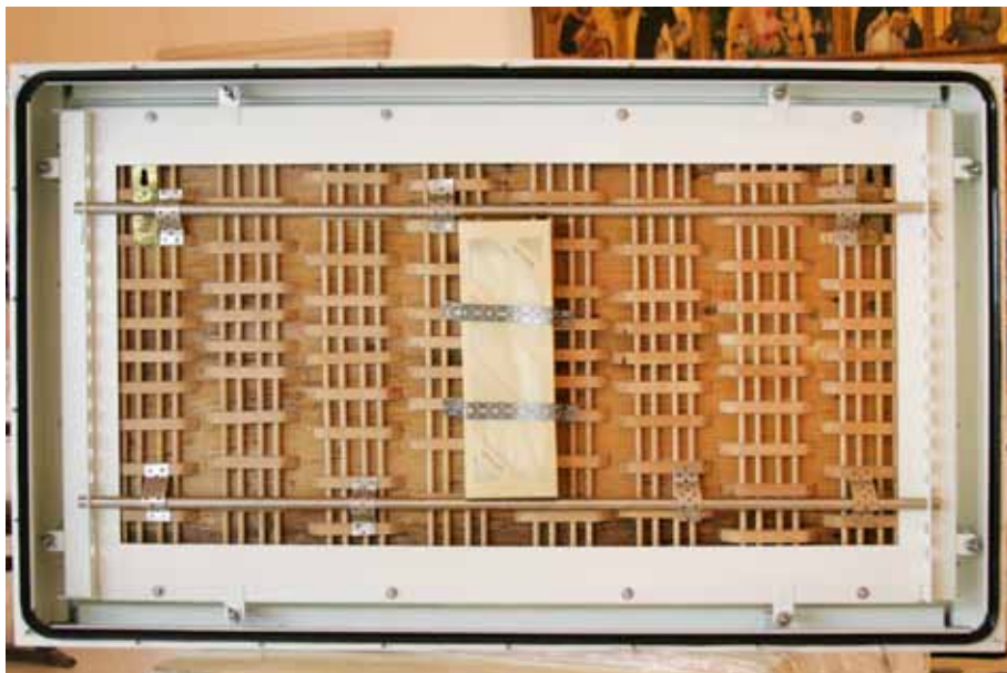
Slika 4. Poledina slike prije zatvaranja komore pokazuje način pričvršćenja silika gela i slike za komoru
