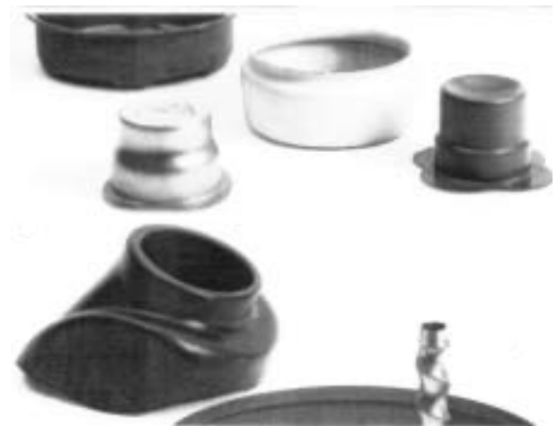
Figure 13. The different products produced by fluid forming Slika 13. Različiti proizvodi dobiveni oblikovanjem pomoću fluida
