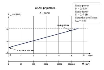
Figure 3. Diagram shows dependency of the radar range on the reflective surface of the target 4 Slika 3. Dijagram prikazuje ovisnost radarskog dometa na površinu koja reflektira cilja br. 4
