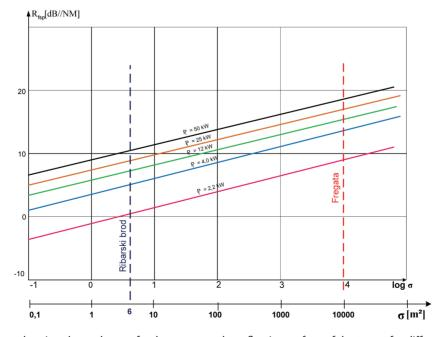
Figure 4. Diagram showing dependance of radar range on the reflective surface of the target for different radars 4 Slika 4. Dijagram koji pokazuje ovisnost radarskog dometa o površini cilja koji reflektira za različite radare 4
