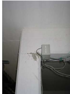
(d) Col. 4 after 0.20g PGA test
