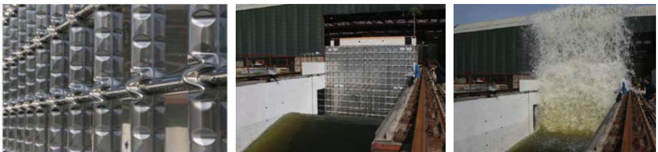
Figure 6 Quasi full scale impact experiments (Sloschel project) Slika 6 Mjerenja kvazi naravnih udara (projekt Sloschel)
