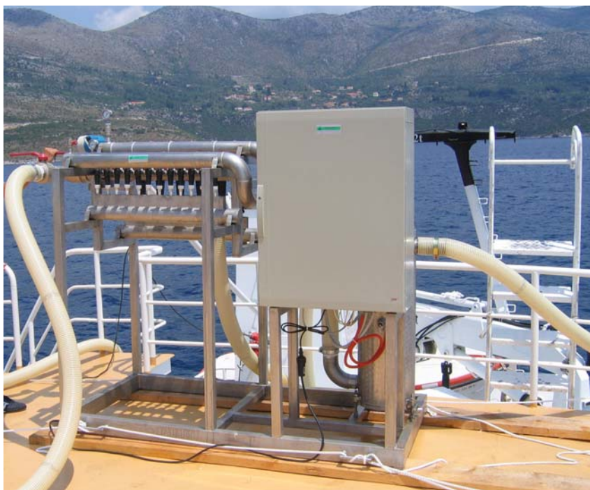
Slika 1. Pilot-uređaj za obradu vodenog balasta postavljen na gornjoj palubi broda „Naše more“ Figure 1 Pilot-plant for ballast water treatment on the upper deck of the vessel Naše more
