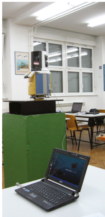
Slika 3.2. Topcon GLS-1500 povezan pomoću USB-a na računalo
