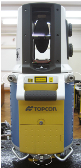
Slika 3.1. Prikaz držača za rotaciju skenera u vertikalnoj ravnini
