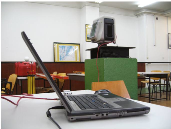
Slika 3.8. Trimble GX200 povezan pomoću LAN kabela na računalo
